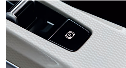
Электромеханический стояночный тормоз с функцией Auto-Hold
